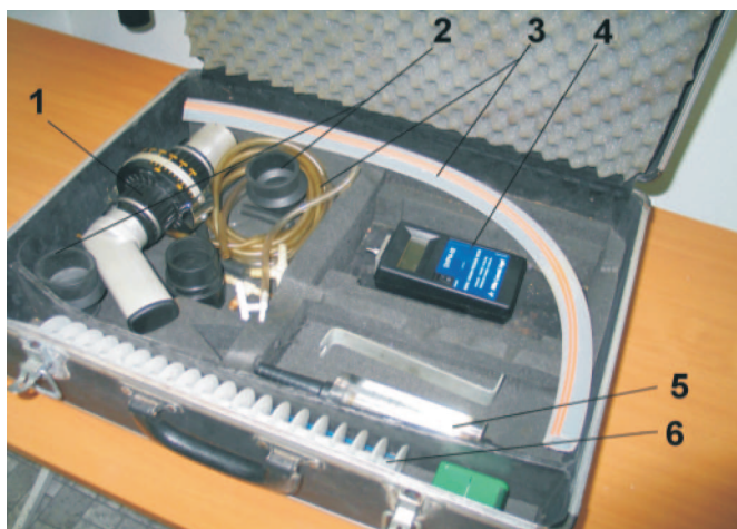
Rys. 2. Zestaw pomiarowy z przepływomierzem AFM 3000 firmy DeLaval: 1 - przepływomierz powietrza, 2 - elementy łączeniowe, 3 - przewody elastyczne, 4 - wakuometr elektroniczny, 5 - rotametr, 6 - zatyczki Fig. 2. DeLaval measuring set with airflow meter AFM 3000: 1 - airflow meter, 2 - connection elements, 3 - flexible tubes, 4 - electronic vacuum gauge, 5 - rotameter, 6 - teatcup plugs
