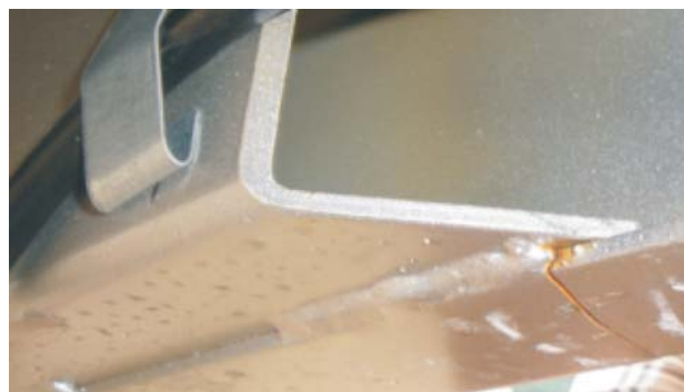
Rys. 5. Widok pęknięcia w prawej podłużnicy ramy naczepy kategorii O3
