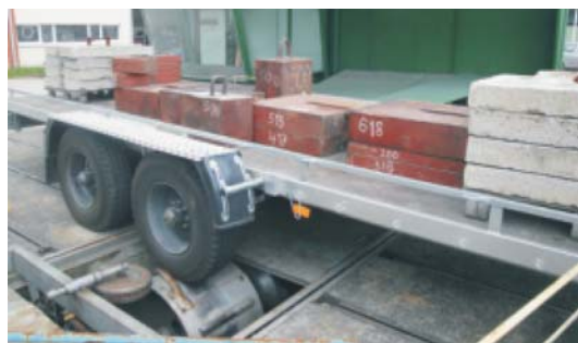
Rys. 4. Widok bębna stanowiska podwoziowego, z progami symulującymi jazdę pojazdu po nierównościach drogi (bruzdy, koleiny)
