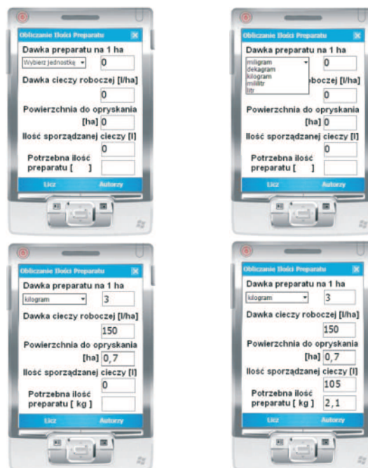
Rys. 3. Widok kolejnych kroków korzystania z aplikacji do obliczania ilości cieczy roboczej (wody) i preparatu
