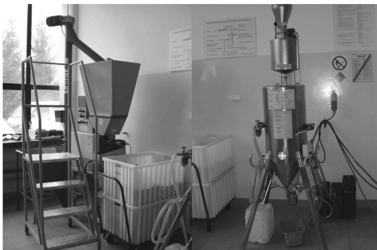
Fot. 1. Prasa śrubowa i estryfikator W60 firmy PROMAR – laboratorium biopaliw Photo. 1. The screw press and the esterizer W 60 PROMAR – biofuels lab
