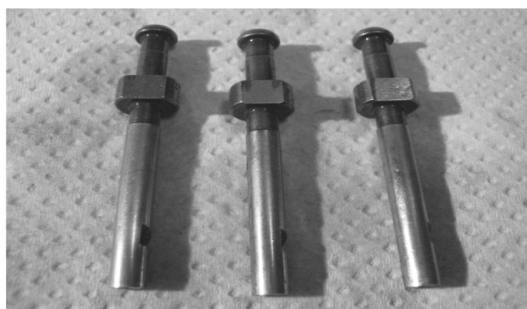
Fot.4 . Fotograficzny obraz tłoczka sekcji tłoczącej pompy wtryskowej (od lewej) – stan wyjściowy, – test w kontakcie z ON, – test w kontakcie z biopaliwem
