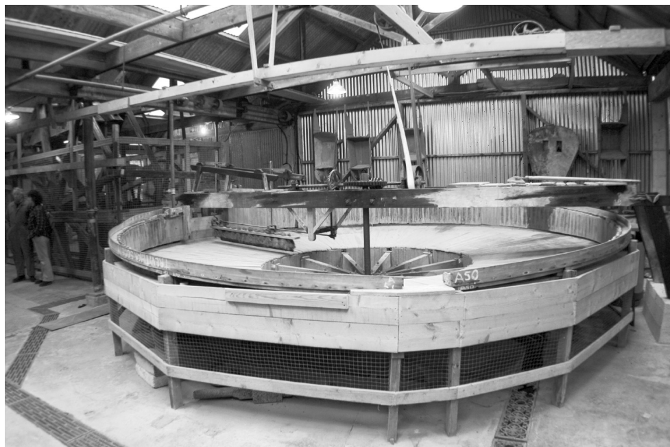
Fot. 2. Drewniane maszyny do grawitacyjnej separacji rudy cyny. King Edward Mine (Kornwalia) (fot. autor) Phot. 2. Wooden machine for gravitational tin-ore separation. King Edward Mine (Cornwall)
