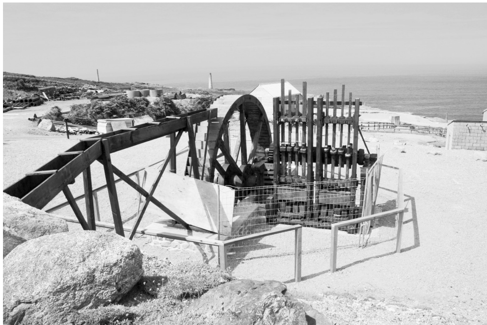
Fot. 1. Rekonstrukcja koła wodnego i stampów. Geevopr (Kornwalia) (fot. autor) Phot. 1. Reconstruction of the water-wheel and stamps. Geevor (Cornwall)
