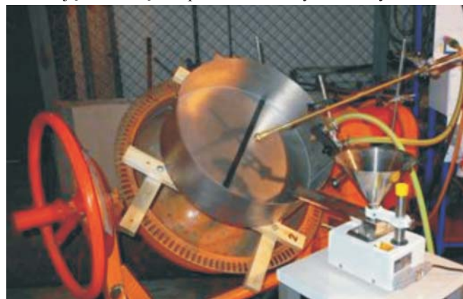
Rys. 3. Talerz granulacyjny z dozownikiem ciała stałego Fig. 3. Granulation plate with dispenser of solids
