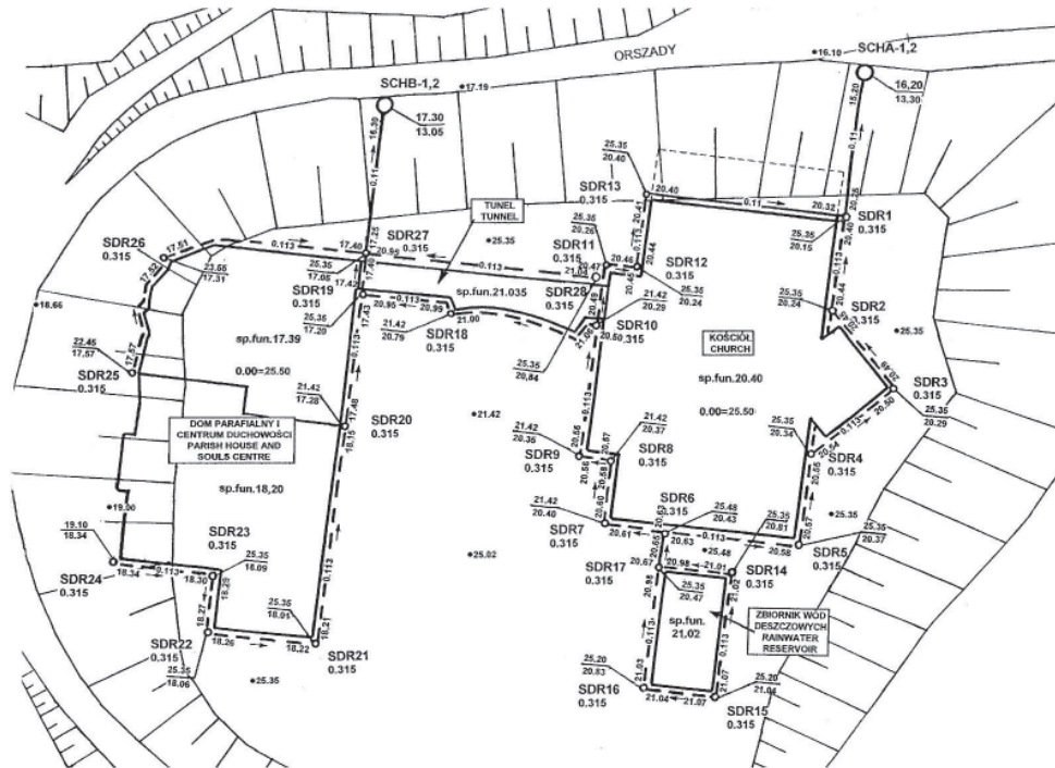
RYSunEK 4. Plan drenażu ze studniami chłonnymi i średnicy 1,2 m FIGURE 4. Scheme drainage and absorbing wells of diameter 1.2 m
