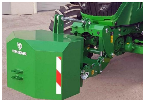
Rys. 2. Obciążnik zawieszany na przednim TUZ ciągnika (METAL-PLAST) [13]
