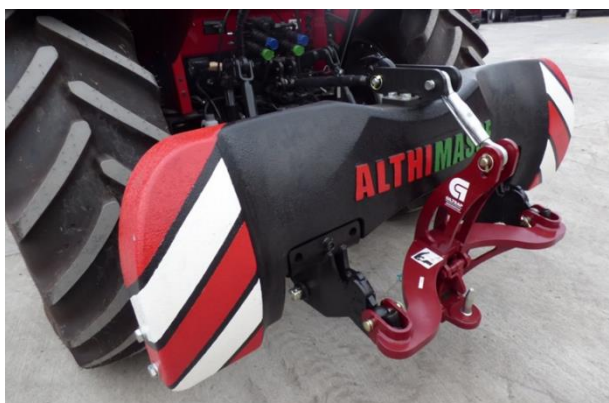
Rys. 11. Obciążnik tylny z zaczepem (Althimasse) [22]
