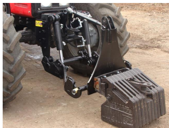
Rys. 5. Obciążniki walizkowe zawieszane na przednim TUZ [16]
