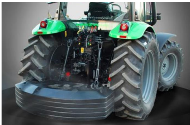
Rys. 10. Obciążnik tylny (Kaber) [21]
