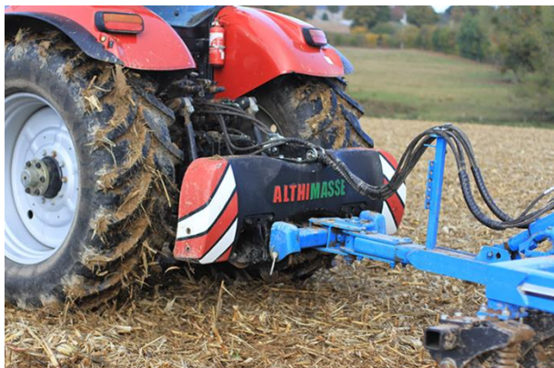
Rys. 12. Obciążnik tylny (Althimasse) przed maszyną półzawieszaną [23]
