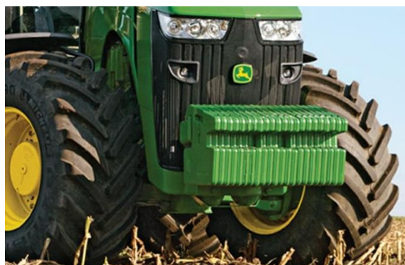
Rys. 1. Przednie obciążniki walizkowe mocowane na ramie ciągnika (John Deere) [12]
