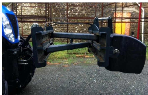
Rys. 6. Balast przedni hydraulicznie wysuwany [24]
