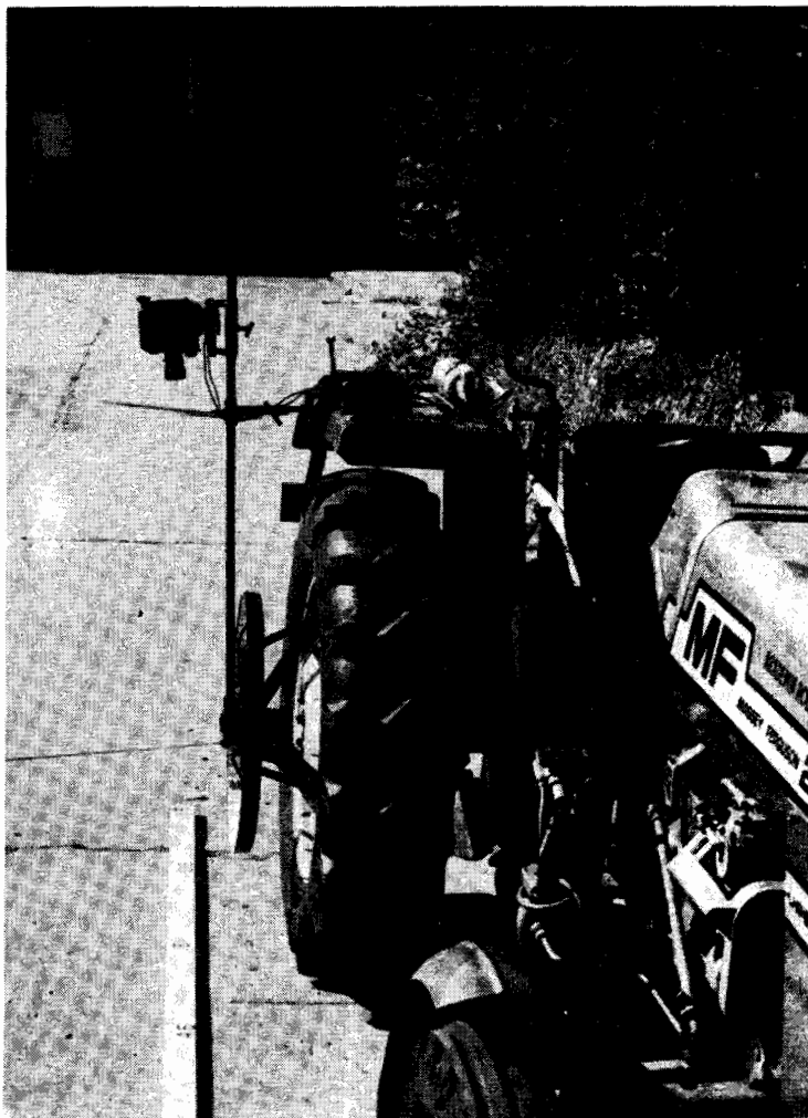
Rys. 3. Ciągnik MF 235 wyposażony w kamerę QUARZ ZOOM DS8-3 przygotowaną do rejestracji poślizgu koła napędowego
