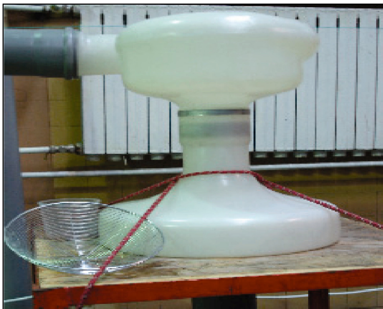
Rysunek 2. Fragment stanowiska badawczego z separatorem fazy stałej Figure 2. Part of the research station with the solid phase separator
