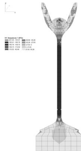
Рис. 9. Распределение изополей нормальных напряжений плоской модели Fig. 9. The distribution of the normal stress contour plots flat model
