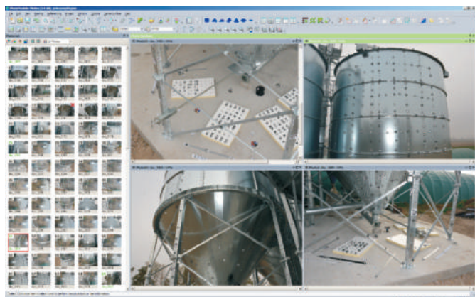
Rys. 2. Interfejs programu PhotoModeler Scanner ze zdjęciami silosu
