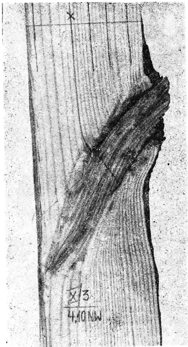
Ryc. 1. Prawidłowy przekrój promieniowy sęka
