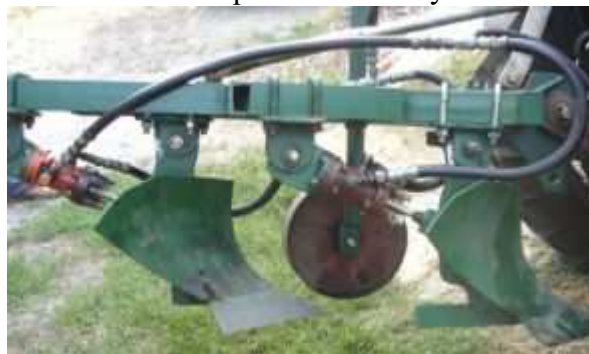
Рис. 2. Специально подготовленный экспериментальный виброплуг ПЛН-2-25 с двумя гидравлическими вибраторами
