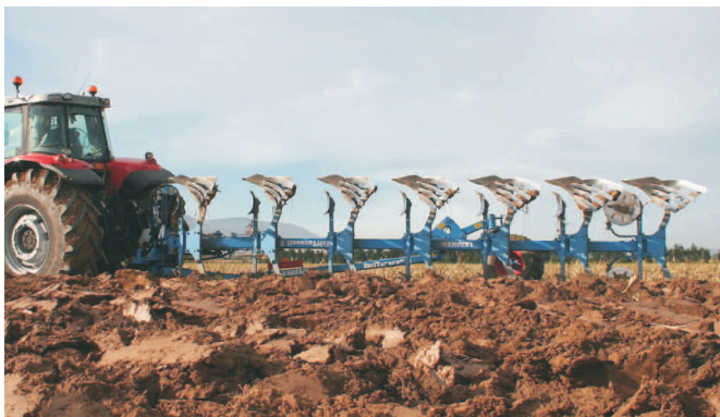
Rys. 3. Model VariTansanit pługa obracalnego hybrydowego produkcji firmy Lemken [9]
