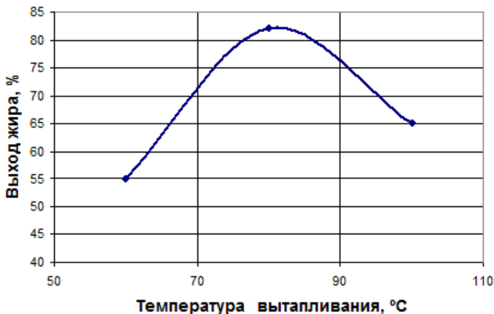
Рис. 1. Зависимость выхода жира от температуры вытапливания
