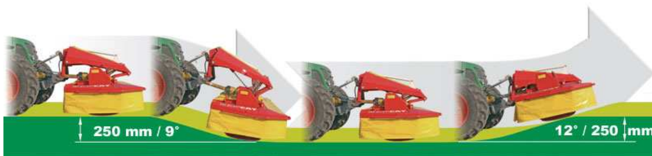
Rys. 2. Pionowe wychylenia ramy kozła wywoływane ruchami kopiującej teren kosiarki czołowej
