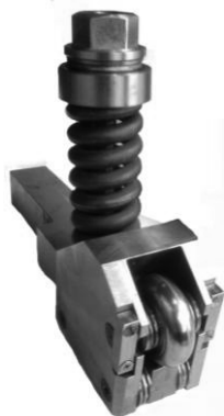
Рис. 1 Устройство для обкатывания деталей торообразным роликом со стабилизацией усилия обкатывания: а) конструктивная схема; б) общий вид
