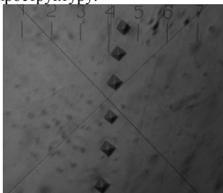
Рис. 7. Измерение отпечатков микротвердости на приборе ПМТ-3 ( \times 500 ) Fig. 7. Measuring of imprints of mikrotverdosti on the PMT-3-3 device ( \times 500 )
