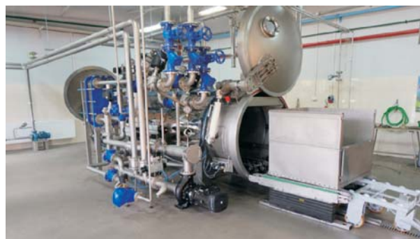
Rys. 2. Model rzeczywisty sterylizatora - prototyp
