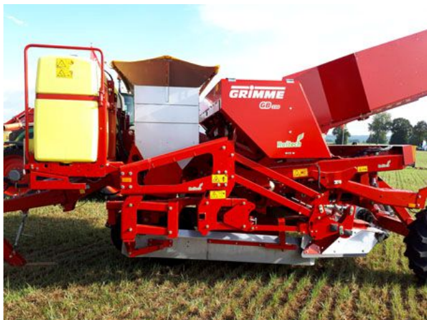
Fot. 9. Urządzenia do zaprawiania montowane na sadzarce
