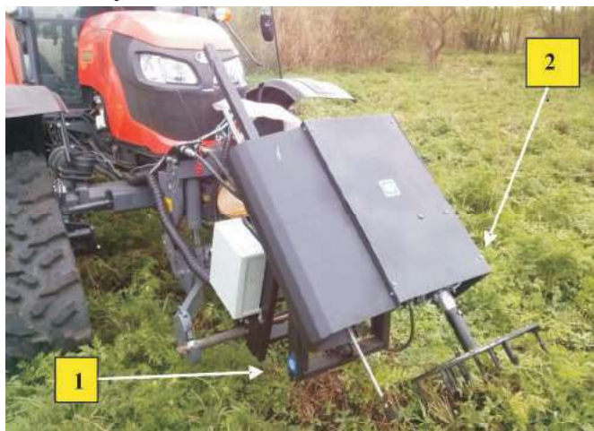
Rys. 1. Widok stanowiska badawczego do pomiarów mechanicznych właściwości górnej warstwy korzeniowej: 1 - moduł sprężystości wzdłużnej, 2 - moduł sprężystości poprzecznej Fig. 1. View of the research station for measuring the mechanical properties of the upper root layer: 1 - longitudinal modulus of elasticity, 2 - transverse modulus of elasticity
