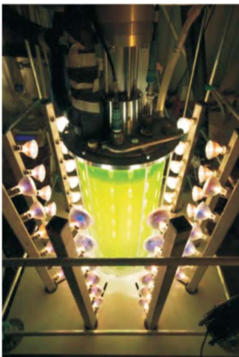
Rys. 5. Reaktor eksperymentalny - Uniwersytet w Wageningen Fig. 5. Experimental photobioreactor - Wageningen University
