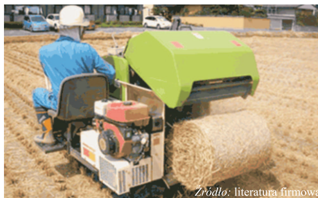
Rys. 3. Samojezdna mini prasa zwijająca JCR0850WKT przeznaczona do pracy na terenach podmokłych podczas wyładunku beli Fig. 3. JCR0850WKT Self-propelled Mini Round Baler specially for working in a muddy field during unloading of bale
