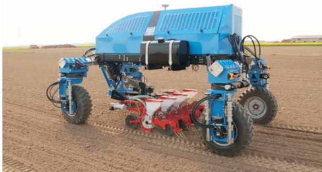
Rys. 1. Autonomiczny robot polowy z modulem do siewu podczas prób
