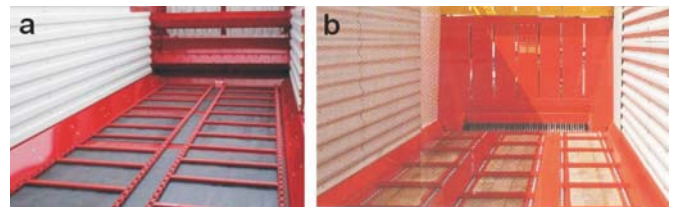
Rys. 4. Podłogi i przenośniki podłogowe stosowane w przyczepach zbierających [10]
