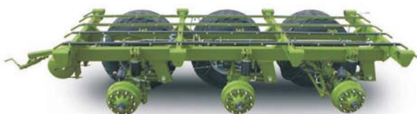
Rys. 6. Zespół osi typu tridem w przyczepach ZX 550 firmy Krone [10] Fig. 6. Unit of axes of tridem type in self-loading trailers ZX 550 of Krone [10]
