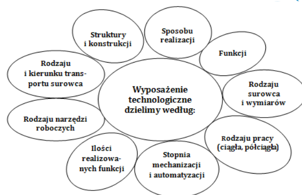
Rys. 2. Próba podziału wyposażenia technologicznego w różnych branżach przemysłu spożywczego według ogólnych cech klasyfikacyjnych
