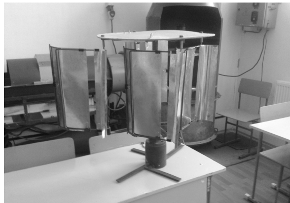
Рис. 7. Лабораторная модель ветродвигателя (вариант лопастей с окнами)
