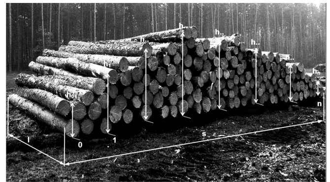
Rycina 1. Elementy pomiaru stosu nieregularnego ( h_0-h_n – wysokość, l – długość stosu, s – szerokość stosu) (Witkowska, Jodłowski 2018)
