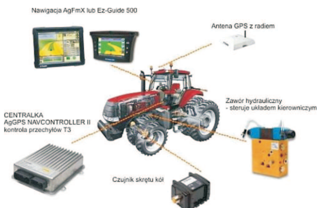
Rys. 2. System automatycznego prowadzenia ciągnika firmy Trimble
