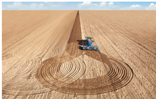
Rys. 4. Precyzyjne naprowadzanie ciągnika na właściwy tor jazdy po nawrocie pętlowym
