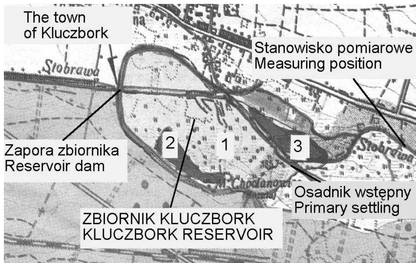
RYSUNEK 1. Projektowany zbiornik retencyjny Kluczbork na rzece Stobrawie (1), stara żwirownia (2) i nowa żwirownia (3) FIGURE 1. The designed Kluczbork storage reservoir at the Stobrawa River (1), the old gravel pit (2) and the new gravel pit (3)
