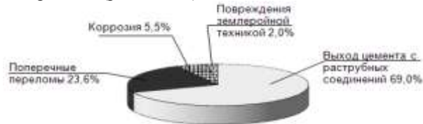
Рис. 17. Виды повреждений чугунных водопроводных труб для четырех городов Украины Fig. 17. Types of defects of iron pipes of four cities of Ukraine
