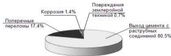
Рис. 5. Виды повреждений чугунных водопроводных труб г. Луцк Fig. 5. Types of defects of iron water pipes of Lutsk city
