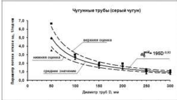
Рис. 11. Аналитическая зависимость \omega_0 = f(D) для чугунных труб г. Кременчуг Полтавской области Fig. 11. Analytical dependence \omega_0 = f(D) for iron pipes of Kremenchug town, Poltava region
