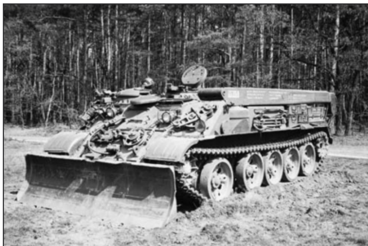
Ryc. 7. Opancerzony wóz zabezpieczenia technicznego (WZT)
