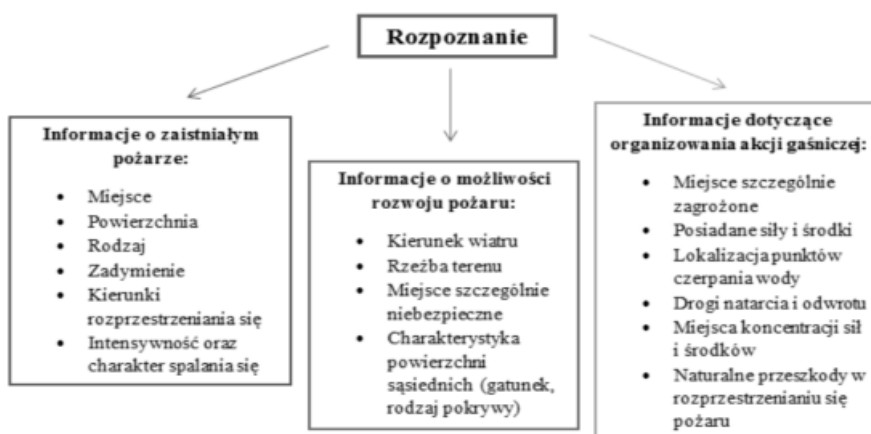
Ryc. 8. Schemat obrazujący elementy rozpoznania w działaniach gaśniczo-ratowniczych podczas pożaru lasu
