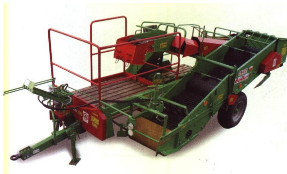
Fot. 5. Kombajn Z 643 Bolko z workownicą
