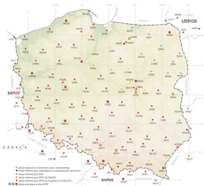
Rys. 3. Naziemna sieć stacji korekcyjnych w systemie ASG-EUPOS [10]
