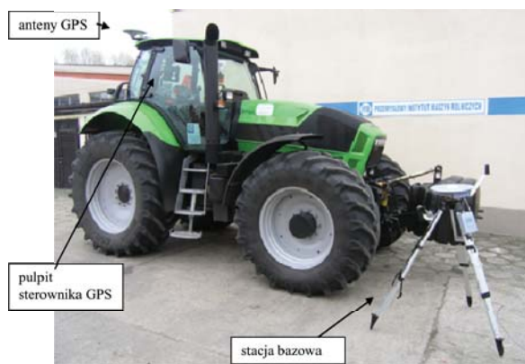
Rys. 2. Ciągnik rolniczy, wyposażony w odbiornik GPS i naziemną stację RTK
