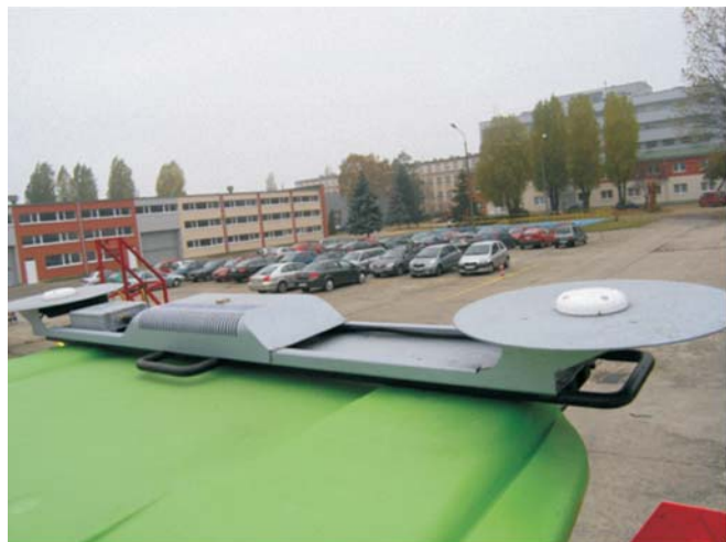
Rys. 5. Dwie anteny GPS, zainstalowane na dachu ciągnika rolniczego dla celów orientacji wektora kierunku jazdy Fig. 5. Double GPS antenna installed on tractor roof for giving the orientation vector of movement direction
