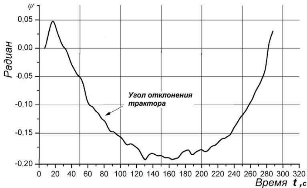
Рис. 2. График расчетной зависимости угла отклонения трактора Fig. 2. Figure calculated depending on the angle of deviation of the tractor
