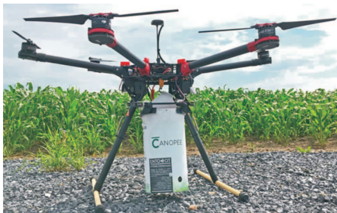
Rys. 7. Dron z aplikatorem do wysypywania kruszynka luzem Fig. 7. Drone with applicator for Trichogramma in bulk
