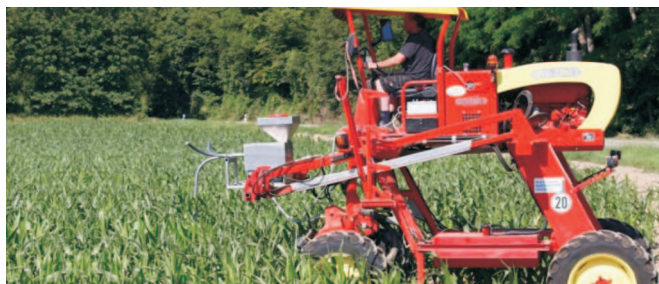
Rys. 3. Aplikacja kapsułek z kruszynkiem za pomocą samo- bieżnego rozrzutnika
