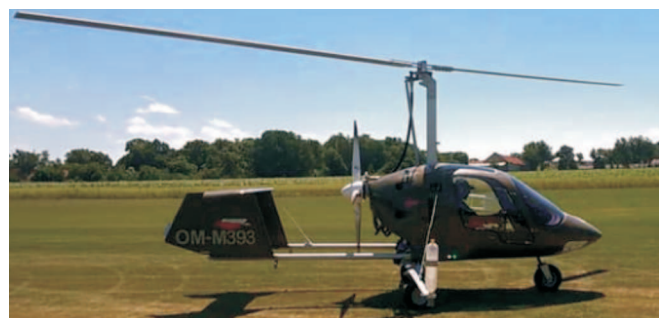
Rys. 4. Wiatrakowiec z aparaturą do rozpraszania kruszynka Fig. 4. Gyroplane with equipment for Trichogramma dispersing
