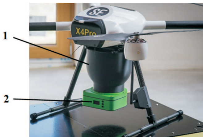
Rys. 5. Quadrokopter z aplikatorem kapsułek: 1 - zbiornik, 2 - konsola sterująca wyrzutnikiem kapsułek
