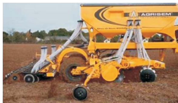
Rys. 6. Agregat uprawowo-siewny Disc-O-Sem (Agrisem) z aplikacją nawozu talerzami brony [10] Fig. 6. Sowing-tillage aggregate Disc-O-Sem (Agrisem) with plate harrow fertilizer application [10]
