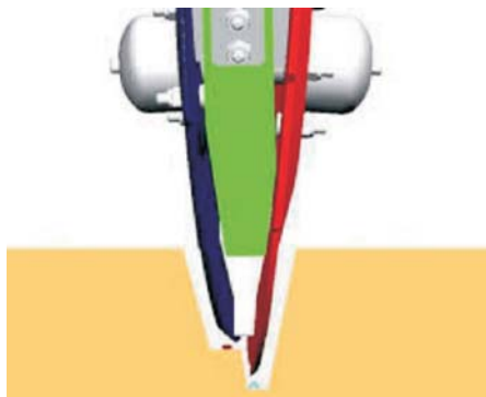
Rys. 8. Redlica dwutalerzowa (Tume-Agri) wysiewająca nawóz i nasiona w oddzielne rowki [7]
