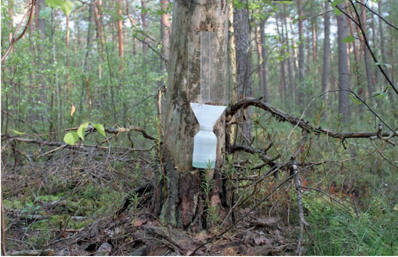
Fot. 1. Pułapka ekranowa typu Netocia napełniona glikolem etylenowym Photo 1. Screen type trap Netocia filled with ethylene glycol
