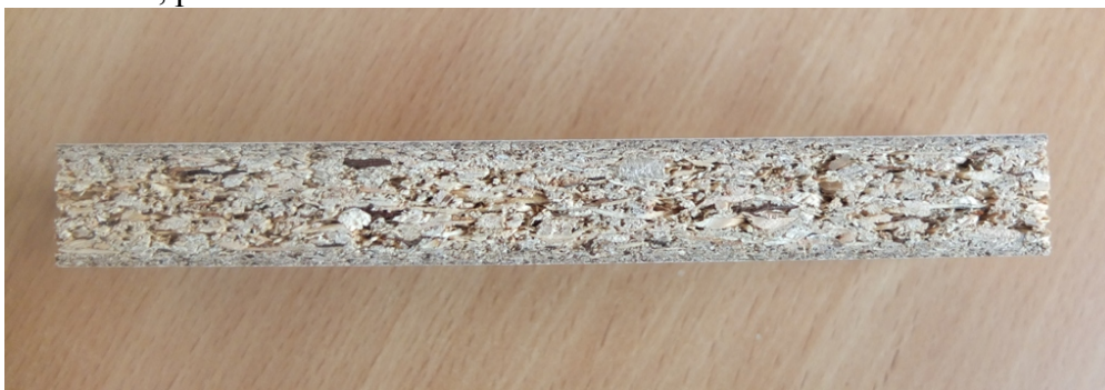
Рис. 2. Материал используемый для экспериментов - древесно - стружечная ламинированная плита
