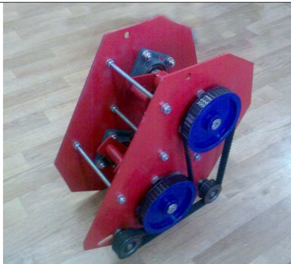
Рис. 9. Вибровозбудитель прямолинейных колебаний двухвального типа с ременной зубчатой передачей
