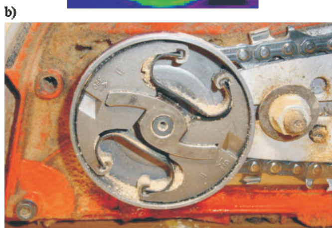
Rys. 3. Sprzęgło pilarki spalinowej, a) termogram, b) widok rzeczywisty
