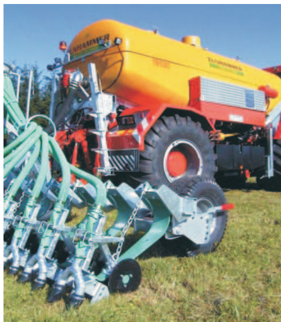
Rys. 1. Mocowanie aplikatora na sprężynie zabezpiecza go przed uszkodzeniem (firma Zunhammer) [1]
