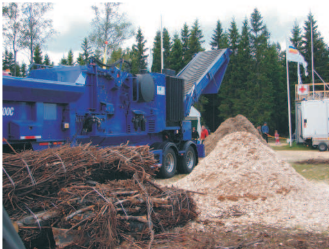
Rys. 8. Maszyna do pozyskiwania biopaliwa z pozostałości pozrębowych
