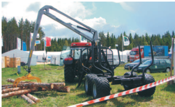
Rys. 2. Ciągnik rolniczy z przyczepą do drewna kłodowanego z żurawiem
