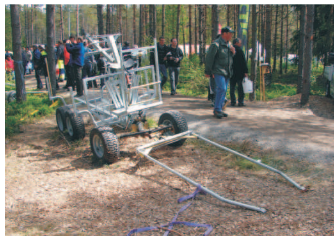
Rys. 6. Wóz konny do zrywki nasiębniernej z mini żurawiem
