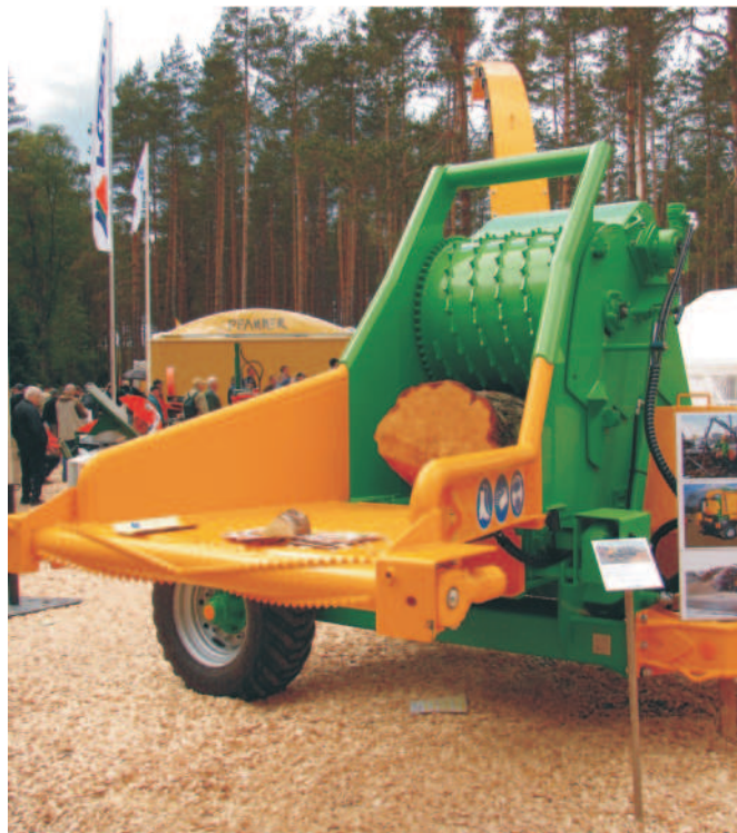
Rys. 9. Maszyna do rozdrabniania dłużycy na zrębki energetyczne
