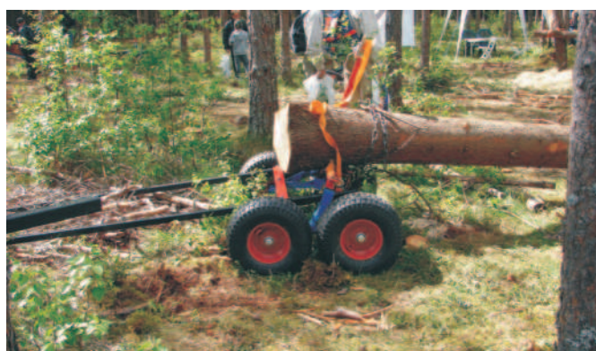
Rys. 7. Dwukółka (w tym przypadku pewnie czterokółka) do zrywki pojedynczych dłużyc sposobem podwieszonym przeznaczona do ciągnięcia przez konia
