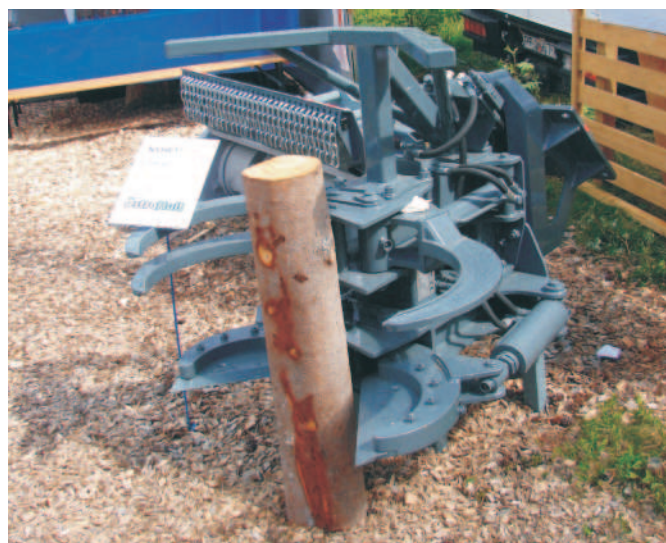
Rys. 3. Głowica ścinkowa z nożami płaskimi
