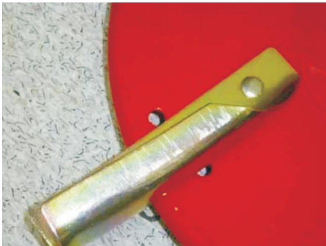
Rys. 1. Tarcza z możliwością zmiany kąta ustawienia łopatek rozsiewających
