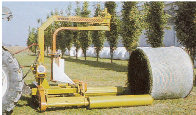
Rys. 2. Owijarka z nieruchomym stołem w formie walców i ruchomym ramieniem firmy Volvo Fig. 2. Wrapping machine with stationary table in the form of rolls and movable arm of Volvo make
