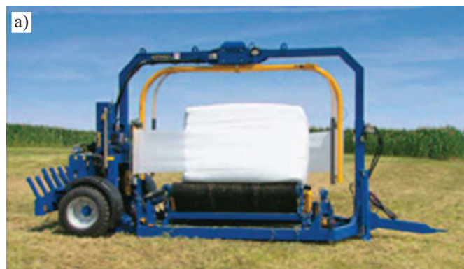
Rys. 2. Owijarka z nieruchomym stołem w formie walców i ruchomym ramieniem firmy Volvo Fig. 2. Wrapping machine with stationary table in the form of rolls and movable arm of Volvo make
