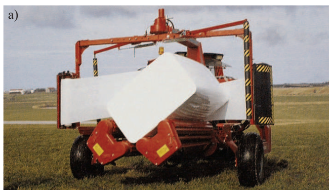
Rys. 2. Owijarka z nieruchomym stołem w formie walców i ruchomym ramieniem firmy Volvo Fig. 2. Wrapping machine with stationary table in the form of rolls and movable arm of Volvo make
