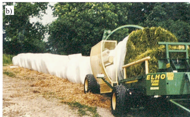
Rys. 6. Owijarki szeregowo firmy Elho: a - owijanie bal cylindrycznych, b - owijanie bal prostokątnych
