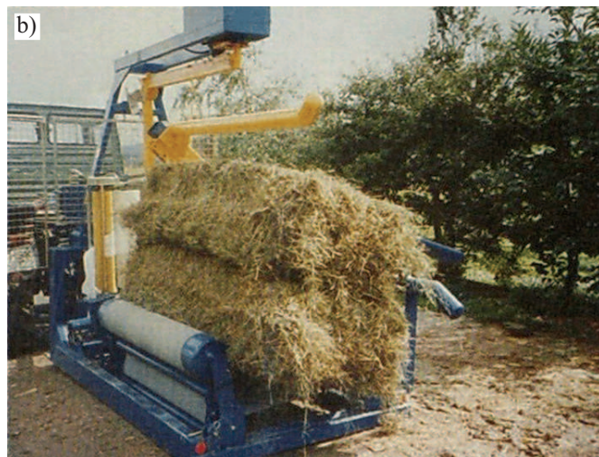
Rys. 4. Owijarka G3010-Q firmy Göweil Maschinenbau podczas owijania dwóch bel; a - owinięte bele, b - bele na stole owijarki Fig. 4. Wrapping machine G3010-Q of Göweil Maschinenbau during wrapping of two bales: a - wrapped bales, b - bales on wrapping table
