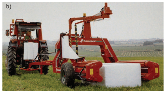
Rys. 3. Owijarka przyczepiana z własnym załadunkiem Skorpion firmy Kverneland z walcami wykorzystywanymi do załadunku beli: a - owijanie; b - wyladunek owiniętej beli Fig. 3. Trailed wrapping machine Skorpion with own loading of Kverneland make with rolls for bale loading: a - wrapping, b - discharge of wrapped bale
