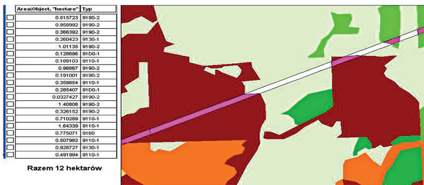
Ryc. 8. Przecięcie obiektów – obiekty z warstwy siedlisk w granicach projektowanej drogi (kolor różowy) – w tabeli typ siedliska i powierzchnia obiektu Fig. 8. Intersection of objects – objects from habitats layer at the area of projected road (pink color) – the code of the habitat and its area
