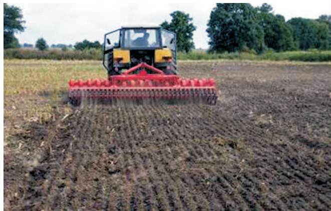
Rys. 8. Wał pierścieniowy pozostawia na powierzchni pola rowki
