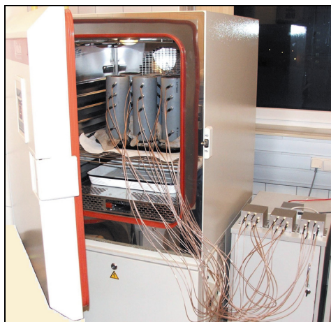
Fot. 3. Komora klimatyczna z monolitami glebowymi wzbogaconymi różnymi dawkami hydrożelu, podłączonymi do miernika TDR (fot. P. Leciejewski) Photo 3. Conditioning chamber with soil monoliths enrichment in different hydrogel dosage connected to TDR system
