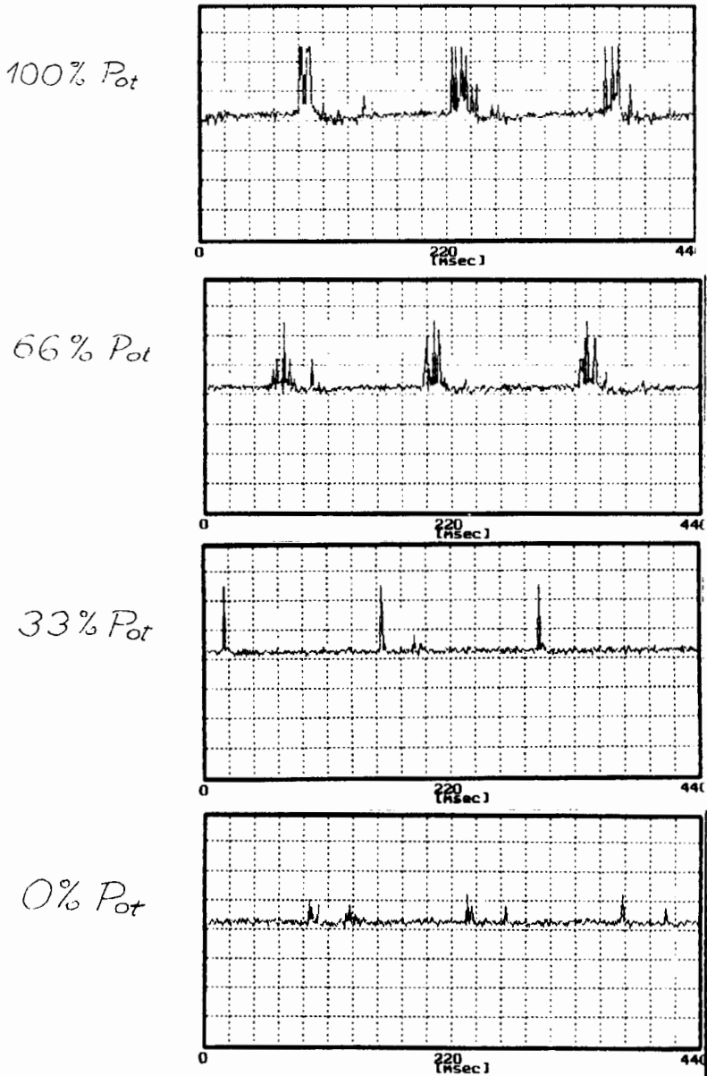
Rys.2 Charakterystyki przebiegu wtrysku paliwa zmierzone czujnikiem magnetodynamicznym dla różnych ciśnień otwarcia
