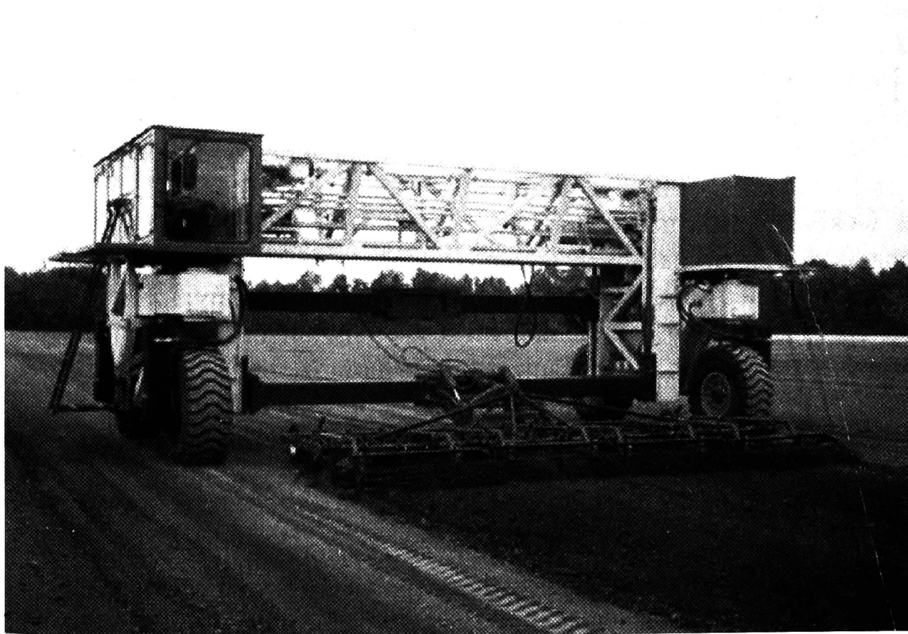
Rysunek 1. Szerokoramowy pojazd skonstruowany w laboratorium USDA-NSDL w Alabamie [źródło: 35]
